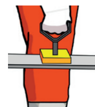
Мал. 5. Переміщення громіздких предметів за допомогою захоплювача із пластиковою голівкою
