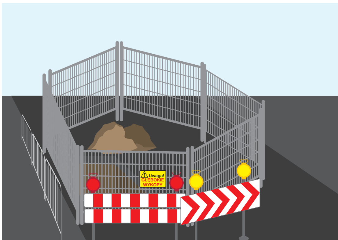
Rysunek 2. Przykład zabezpieczenie wykopu przy pracach pod ruchem
