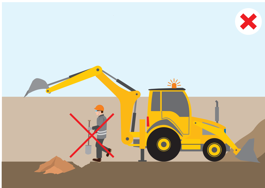
Rysunek 9. Zakaz przebywania w wykopie pod ładunkiem podczas transportu materiałów
