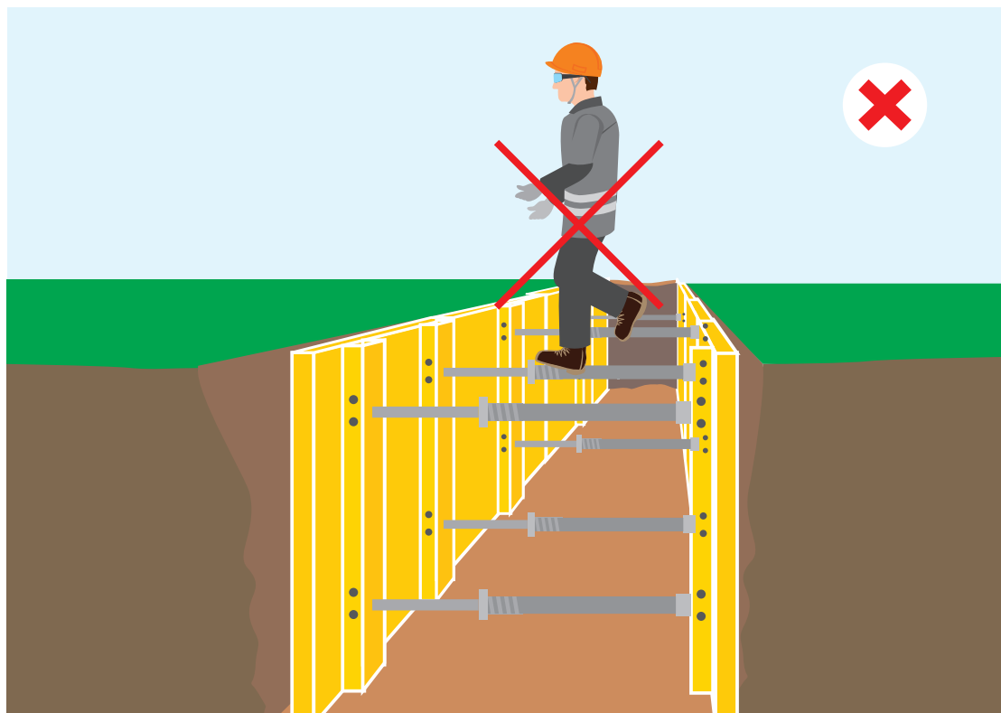
Rysunek 11. Zakaz schodzenia do wykopu oraz wychodzenia z niego po rozporach lub innych elementach obudowy
