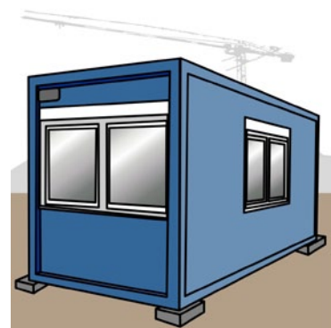
Rys. 5. Usytuowanie kontenera na bloczkach betonowych
