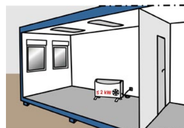
Rys. 4. Ogrzewanie kontenerów ogrzewaczem elektrycznym
