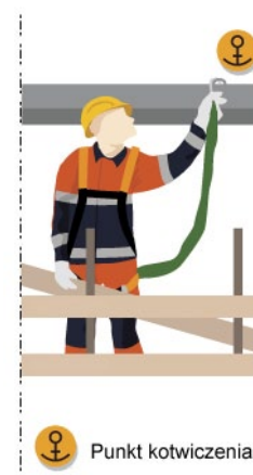
Rys. 2. Ochrona indywidualna przed upadkiem z wysokości
