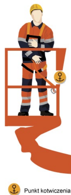
Rys. 1. Punkt kotwienia w podeście ruchomym koszowym
