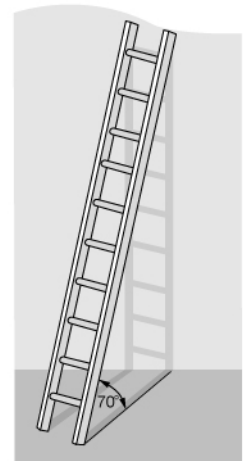
Rys. 5. Dobór właściwego pochylenia drabiny – kąt 70°
