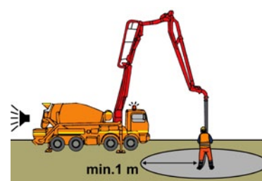
Rys. 2. Zachowanie bezpiecznej odległości przy pracach pompy do betonu
